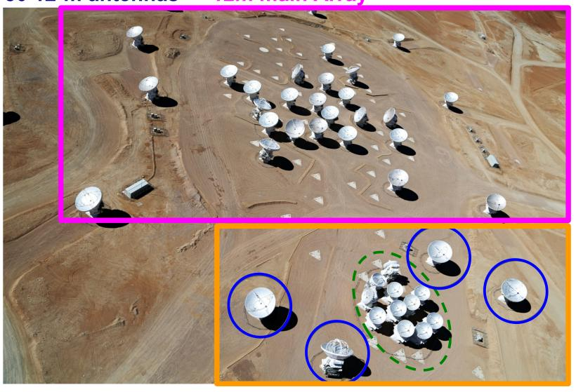
12 7-m antennas → 7-m array 4 12-m antennas → TP array
